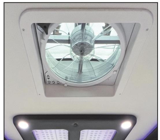
Maxxair Fan & Ceiling Lighting
